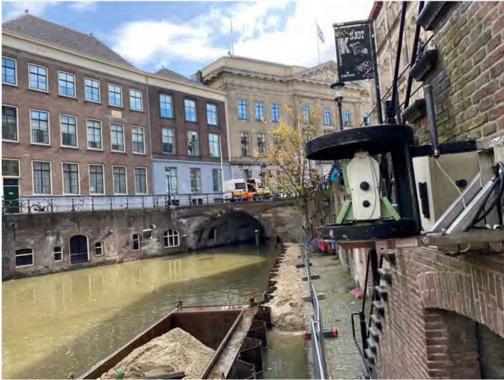
Figuur 4: Voorbeeldfoto Robotic Totalstation Leica TS40
